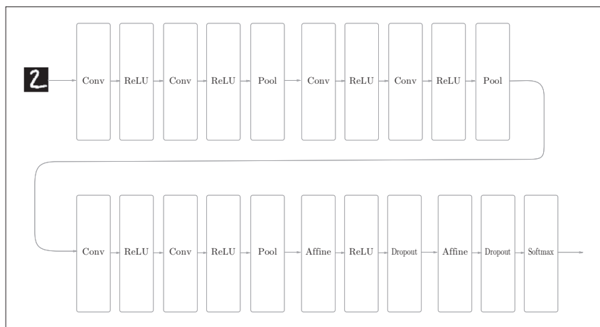
图 8-1 进行手写数字识别的深度 CNN
