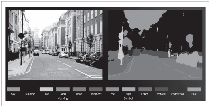
图8-25 基于深度学习的图像分割的例子：道路、车辆、建筑物、人行道等被高精度地识别了出来(引用自文献[43])
